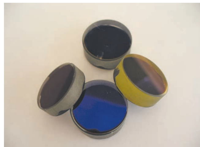
Линзы с многослойным покрытием, произведённые на новом оборудовании
